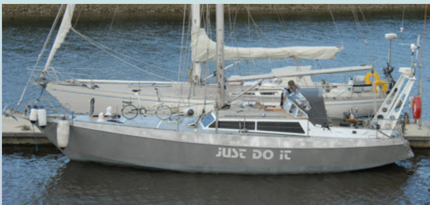
JUST DO IT 2010 nach dem ersten Teil-Refit: Rumpf gesandstrahlt, Alu natur, geschliffen, Deck und Aufbau neu beschichtet, Fenster neu eingesetzt, Segel überholt. Sprayhood erneuert ...
